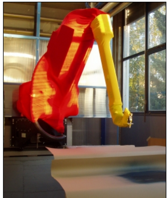
Roboter Gelcoatspritzten bei ELAN Marine in Slowenien
