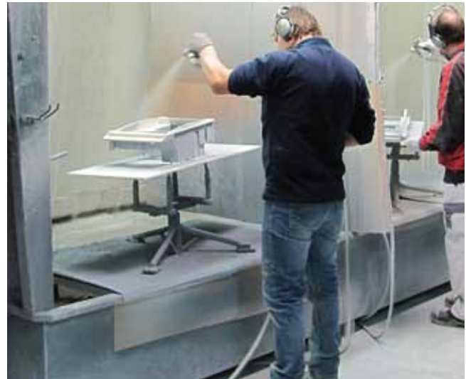
Die Reduzierung des Oversprays um 20% konnte bei der Entsorgung des Lackschlammes eindeutig nachgewiesen werden.
