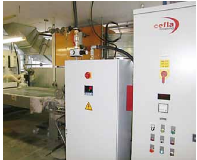
Die Heizung ermöglicht es, mit höherer Viskosität zu arbeiten
