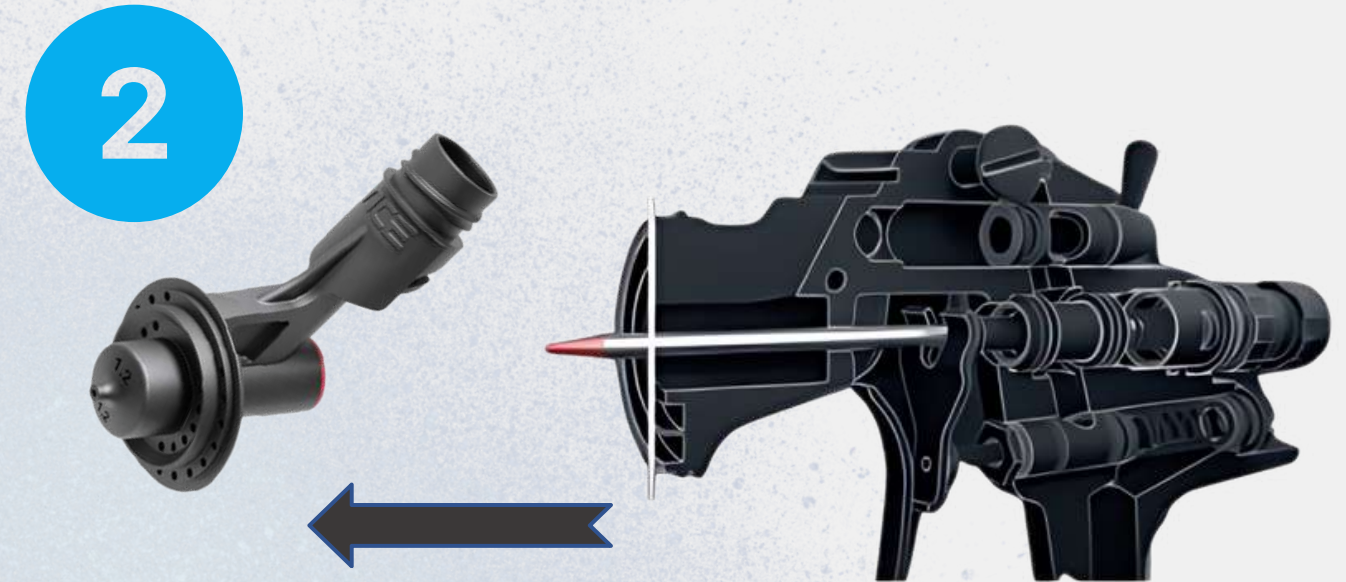
2. Lépés Fúvóka tű tömítéssel együtt lehúzni a pisztolyházból és az anyagtűről a pisztoly test belső rész tiszta marad csak az anyagtű hegyét kell letörölni
