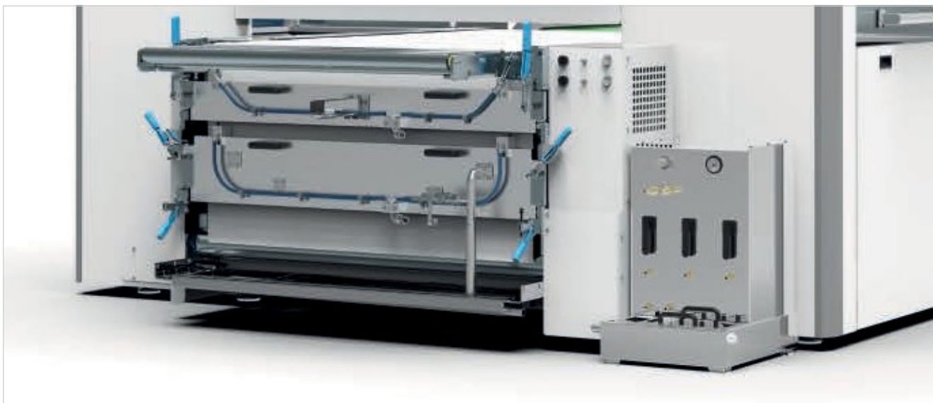
Kétfokozatú gumibetétes festékvisszanyerő és fő szállítószalag-tisztító rendszer.
