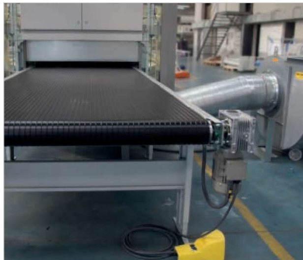
Rakodó szállítózsalag hornyolt szalaggal és lábfékkapcsolóval.
